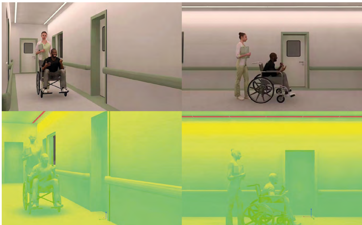
Ил. 2. Фалшиво-цветни визуализации за изследване на развномерността на осветяване в коридор на болница и намаляване на крайните контрасти. Източник: Резултат от анализ в DIALux Evo.
