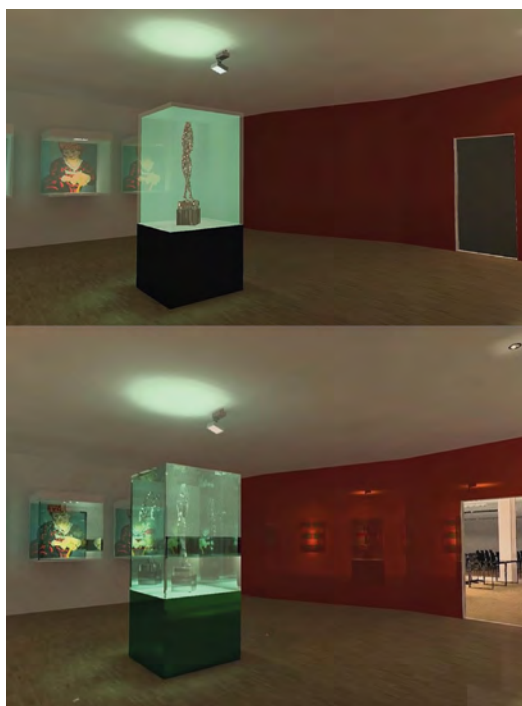
Ил. 1. Трасиране на лъчи и глобално осветяване чрез конкретни материали и пространствени обеми. Пример в изложбени и образователни зали. Източник: Резултат от анализа на DIALux Evo.
