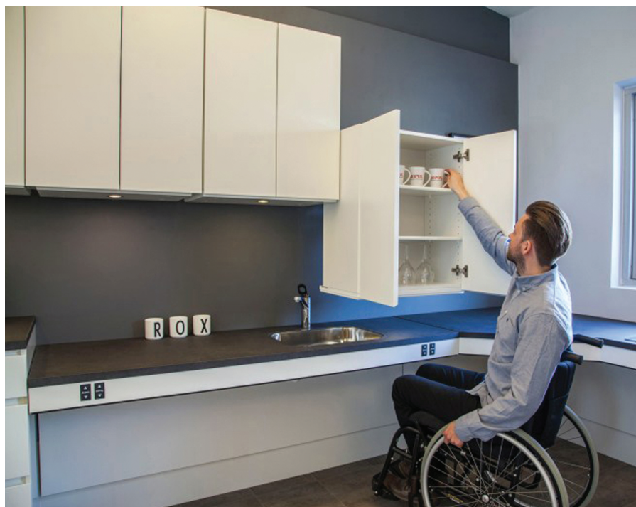
ил. 79. Кухня в жилищна среда, предназначена за хора с увреждания. Горният ред е с опция за промяна на височината чрез механизъм. Rorox. 2016 г.
