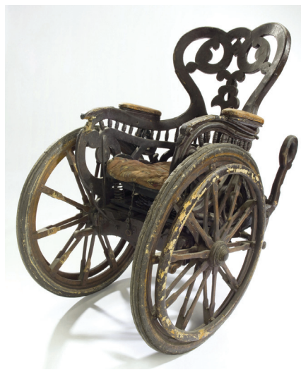
ил. 70. Първият модел на инвалидна количка със задни бутални колела. Количката притежава кухи, гумени колела и допълнителни релси от страни за собственоръчно придвижване. Патент от 1869 г
