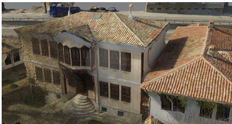
Ил. 6. Наслагване на резултатите от наземното и въздушното заснемане
